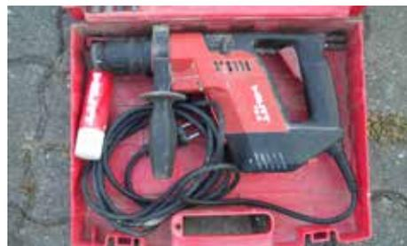
Speziell für Dübelarbeiten bis 18 mm geeignet, TE 5
